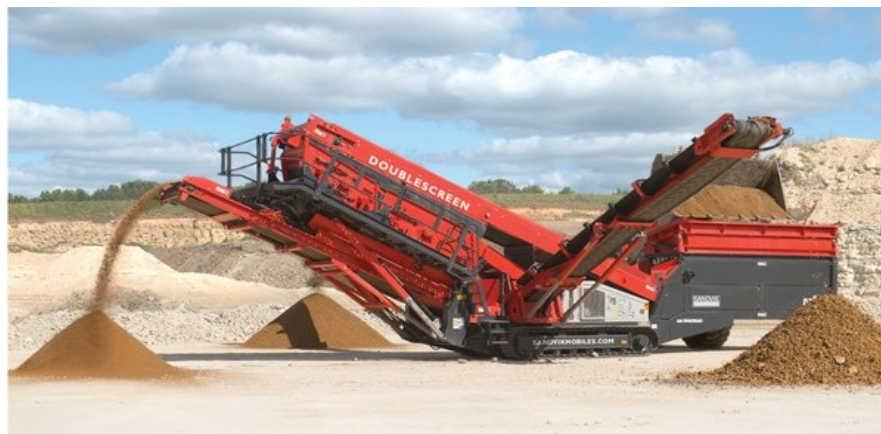
Rys. 1. Przesiewacz mobilny QA335 Mobile doublescreen [3]
