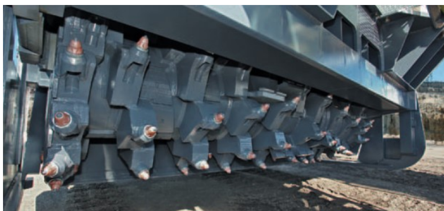
Rys. 6 Widok bębna frezującego kombajnu 2200 SM firmy Wirtgen przeznaczonego do urabiania skał o R_c \leq 50 MPa [9]
