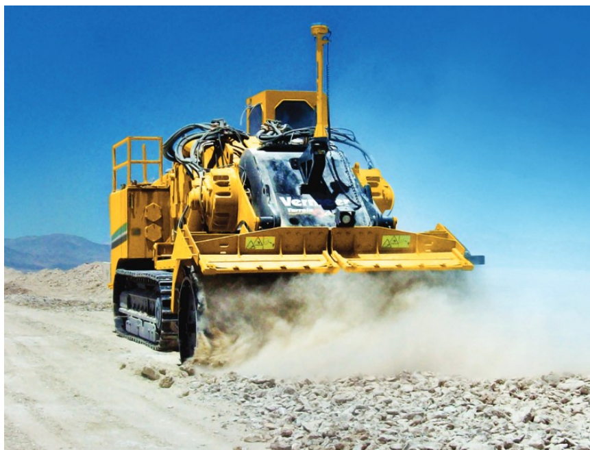
Rys. 1 Widok kombajnu frezującego TL 1255 firmy Vermeer podczas urabiania złoża wapienia [10]
