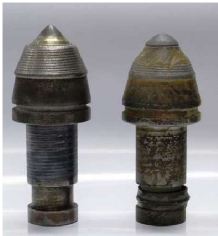
Rys. 4.1. Nóż zabezpieczony warstwą trudnościeralną po 2 tygodniach pracy [10]
