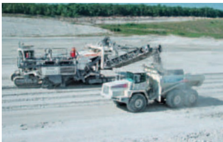
Rys.4 Kombajn 2200 SM firmy Wirtgen współpracujący z wozidłem [9]
