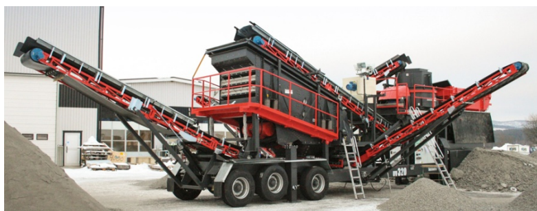
Rys. 10. Semimobilny zestaw krusząco sortujący UV320 firmy Sandvik [3]
