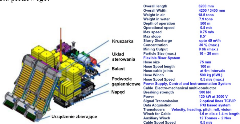
Rys. 4. Aktywny agregat mechaniczny produkcji Indyjskiej oraz jego podstawowe parametry [4]
