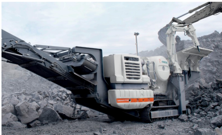
Rys.3. Załadunek kosza zasypowego mobilnego zestawu kruszącego Lokotrack LT120 produkcji METSO [3]
