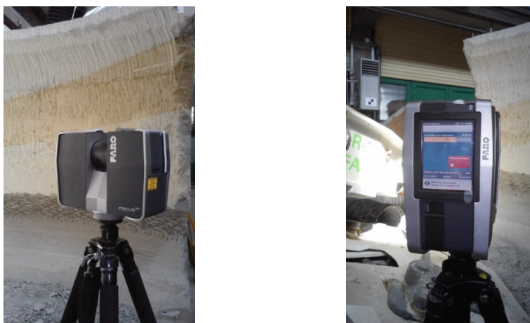
Rys. 4. Skaner laserowy Focus 3D X 130 HDR na stanowisku badawczym w laboratorium Instytut Mechanizacji Górnictwa Wydziału Górnictwa i Geologii Politechniki Śląskiej podczas skanowania powierzchni urabianej wysięgnikowym kombajnem chodnikowym
