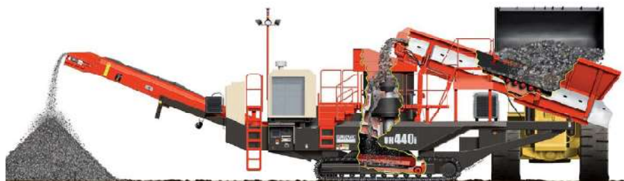
Rys.6 Mobilny zestaw kruszący UH440i produkcji SANDVIK wyposażony w kruszarkę stożkową [3]
