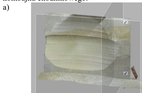
Rys. 6. Etap II – przetwarzanie chmury punktów w środowisku Geomagic Design X: a) wczytanie danych, b) wygenerowania kształtu urabianej powierzchni
