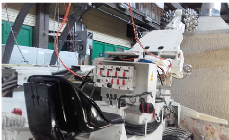
Rys.1. Kombajn chodnikowy R-130 na stanowisku badawczym
