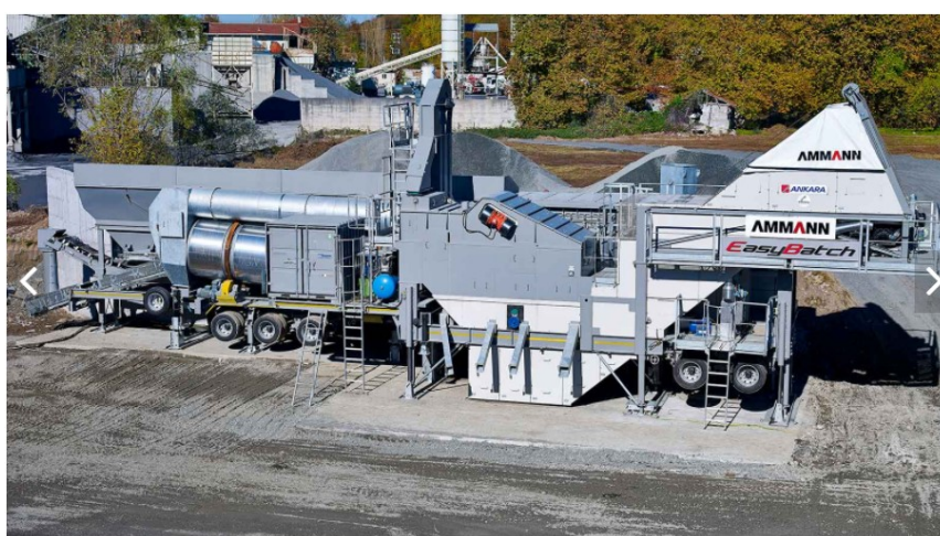
Rys.11. Semimobilna instalacja produkcji mas mineralno-bitumicznych [3]
