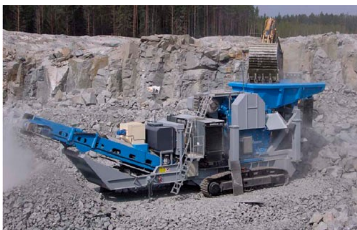
Rys. 4. Mobilny zestaw kruszący UJ640 produkcji SANDVIK wyposażony w jednorozporową kruszarkę szczękową [3]
