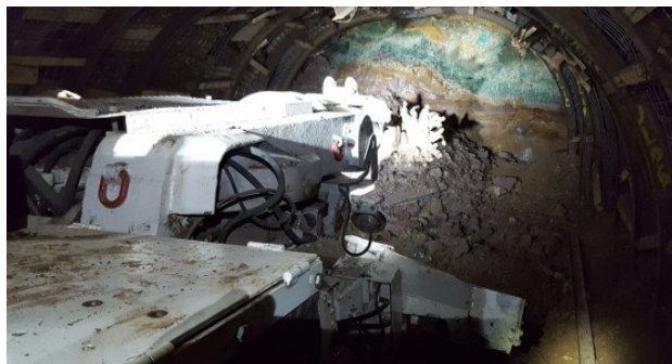
Rys. 3. Kombajn AM-50z w kopalni miedzi Boleo (Meksyk) [9]
