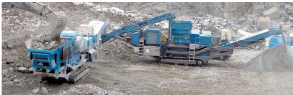
Rys.7 Bezpośrednia współpraca zestawów kruszenia wstępnego i wtórnego [3]
