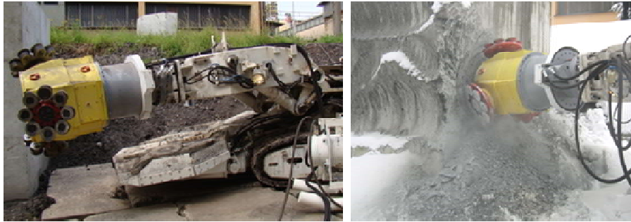
Rys. 8. Widok głowicy z narzędziami dyskowymi na ramieniu kombajnu KR 150 oraz w trakcie prób poligonowych [4]
