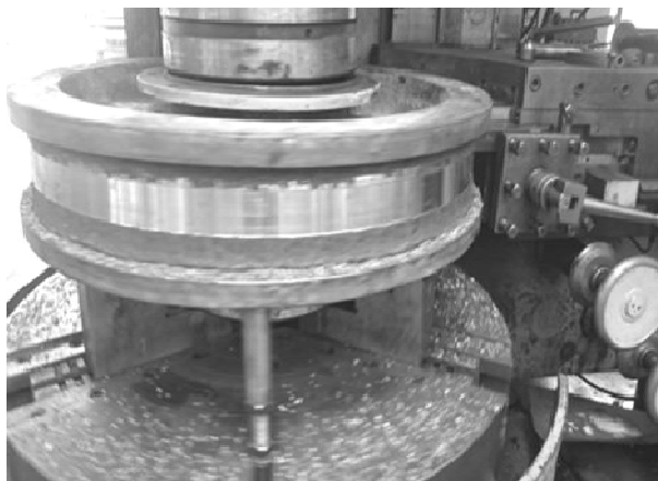
Rys. 13. Regeneracja kół suwnicy.
