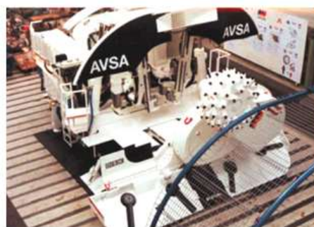
Rys. 8. Budowa i widok kombajnu urabiająco-rozpierającego firmy Sandvik typ AVSA [14]
