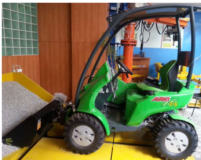
Rys. 1. Modułowe stanowisko do badania procesu ładowania z ładowarką łyżkową Avant 218 [6]
