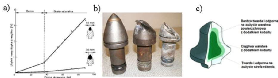
Rys. 2. Noże styczne obrotowe: wpływ wymiarów słupka z węgla spiekane na procentowy ubytek jego masy (a), widok kolejnych etapów nierównomiernego zużycia noży styczno-obrotowych (b), wkładka z węgla spiekane nowej generacji typ DP-717, o warstwowej strukturze, firmy Sandvik (c) [2,3]
