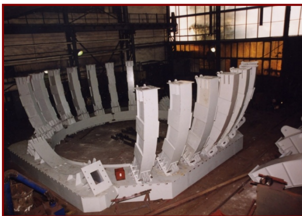
Rys.11. Stalowy dolny pierścień z częściowo zmontowanymi żebrami ociosowymi dwustronnego wlotu szybowego na poz. 960 w szybie 1.4 – próbny montaż [3]
