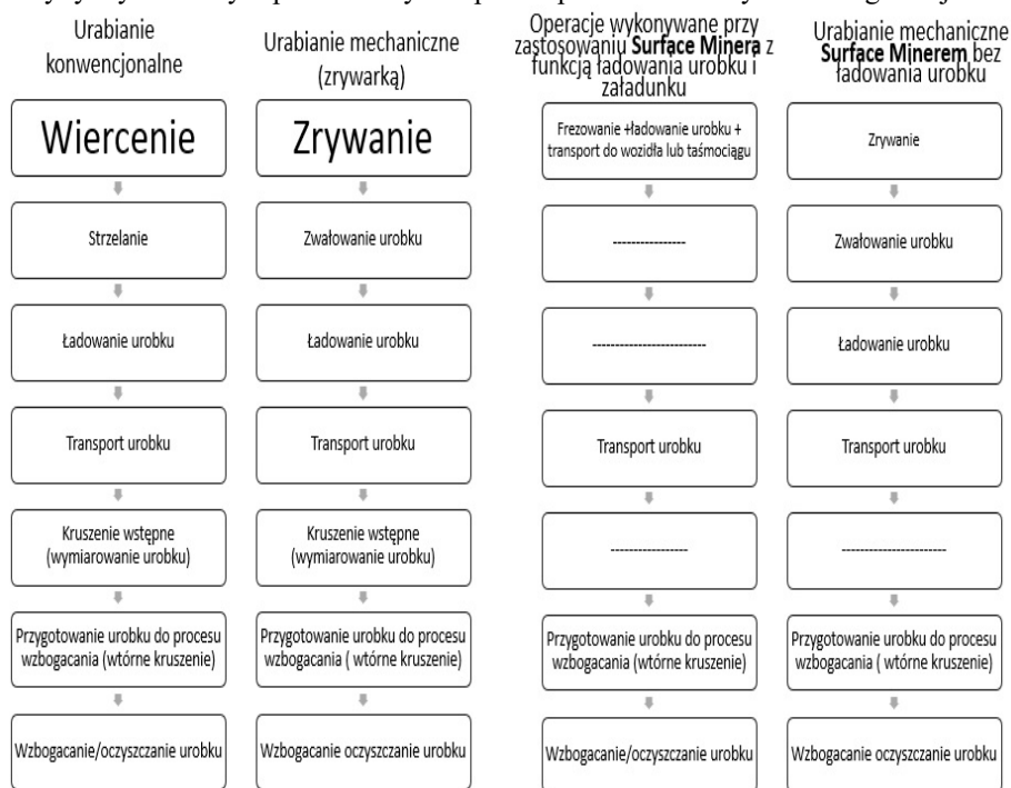
Rys. 11. Porównanie operacji w kopalni odkrywkowej z zastosowaniem konwencjonalnych technologii wybierania i z zastosowaniem maszyn typu Surface Miner .
