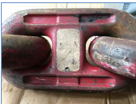
Rys. 7. Stan jednego z ogniw pomiarowych po ok. 220 godzinach pracy
