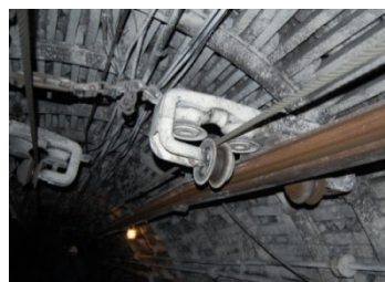
Rys. 3. Podwieszona kolej szynowa (trasa dwuteownikowa) z napędem linowym [9]
