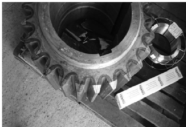
Rys. 9. Regeneracja zębów koparek
