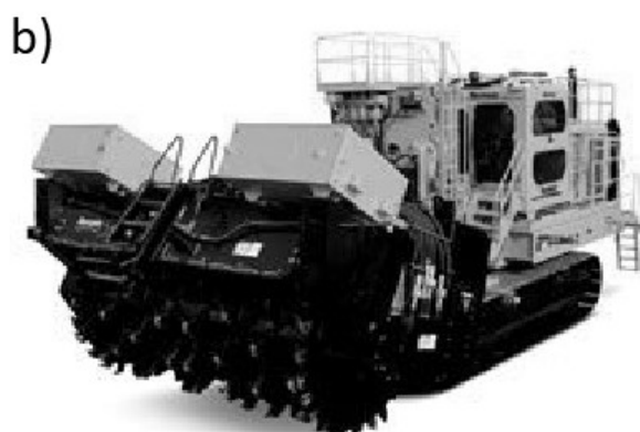
Rys. 7. Maszyny typu Surface Miner z tylnym organem frezującym i przeniesieniem mocy za pomocą łańcucha wrębowego (a) i przekładni mechanicznej (b).
