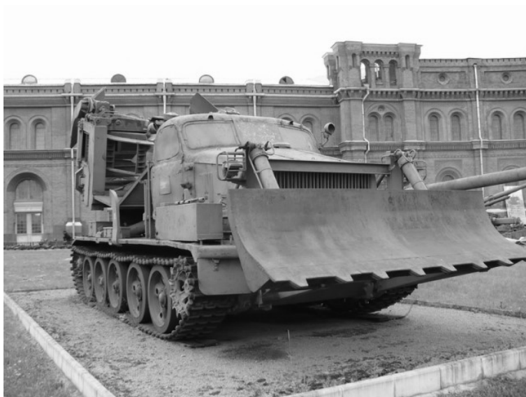
Rys. 6. Maszyna inżynieryjna do kopania okopów z tylnym kołem wieloczerpakowym typu MDK-2 jako protoplasta jednej z odmian Surface Miner .
