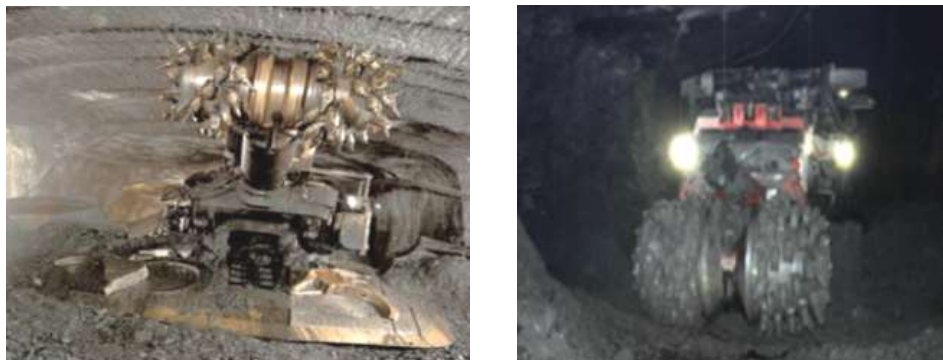
Rys. 4. Kombajn firmy VOEST ALPINE BERGTECHNIK – Alpine Miner AM-75 (a) oraz kombajn produkcji firmy SANDVIK MH620 (b) [14]
