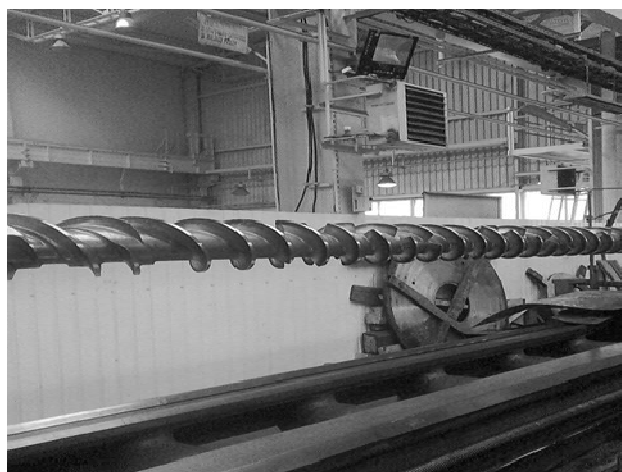
Rys. 7. Regeneracja ślimaków transportowych.
