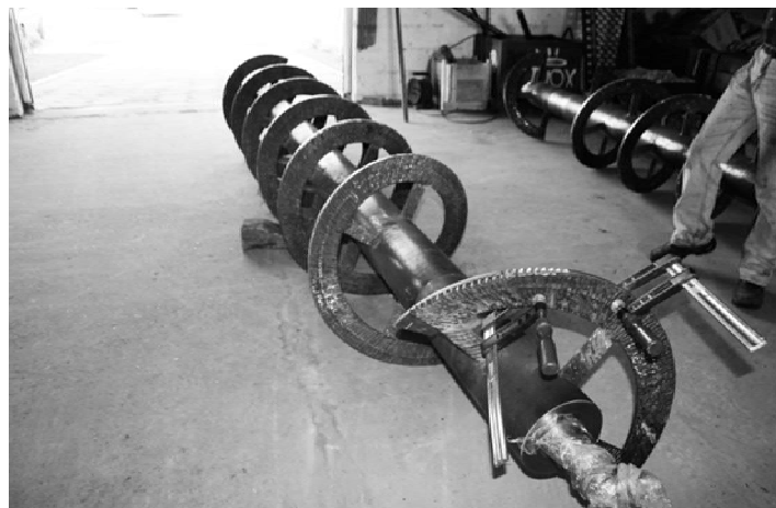
Rys. 6. Regeneracja ślimaków transportowych.
