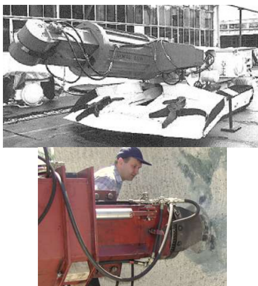
Rys. 7. Prototyp kombajnu RDA-1 z aktywnym narzędziem dyskowym oraz widok głowicy [6]
