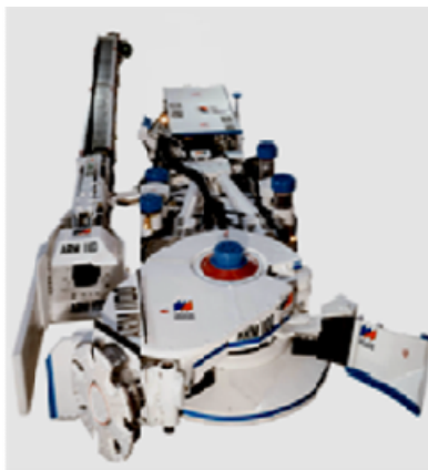
Rys. 9. Kombajn ARM 1100 firmy Voest Alpine wyposażony w głowicę uzbrojoną w asymetryczne narzędzia dyskowe [15].
