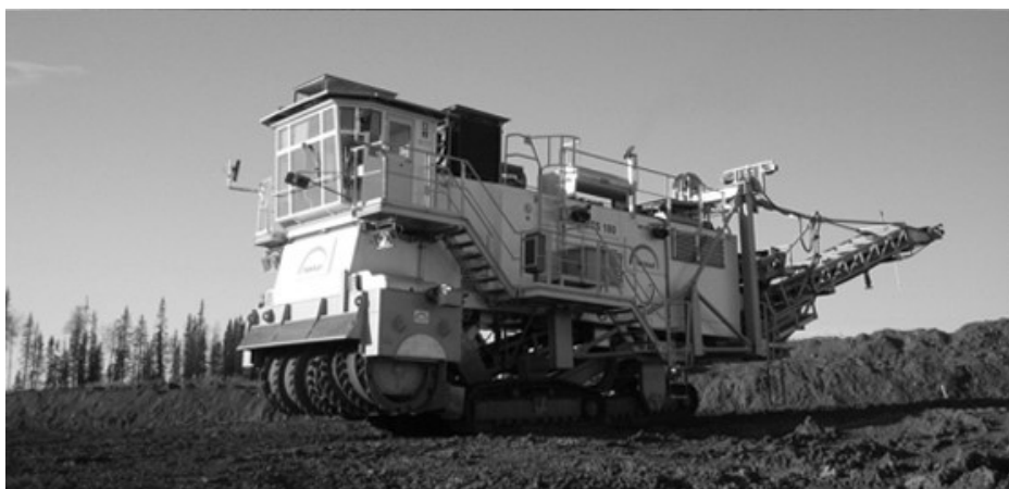
Rys. 10. Surface Miner SM 2500 firmy TakrafTenova z przednim organem frezującym.
